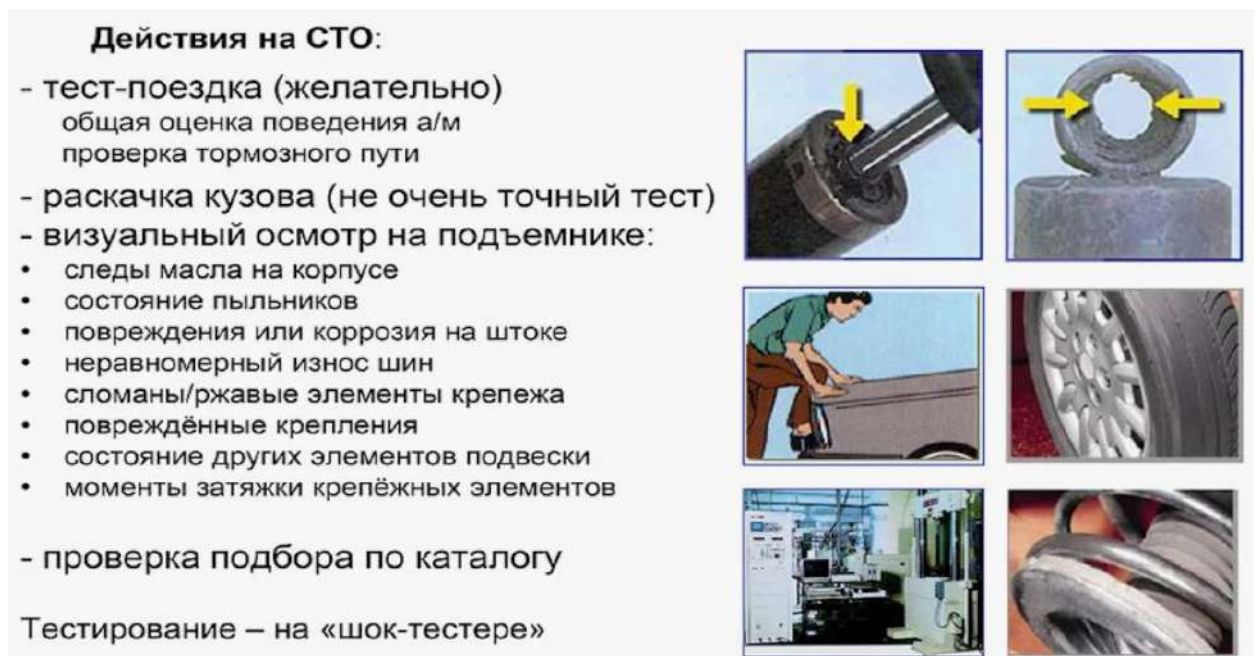
Рисунок 3. Проверка амортизатора без демонтажа
