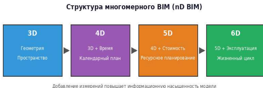
Рис. 2. Структура многомерного BIM: от геометрии к управлению жизненным циклом
