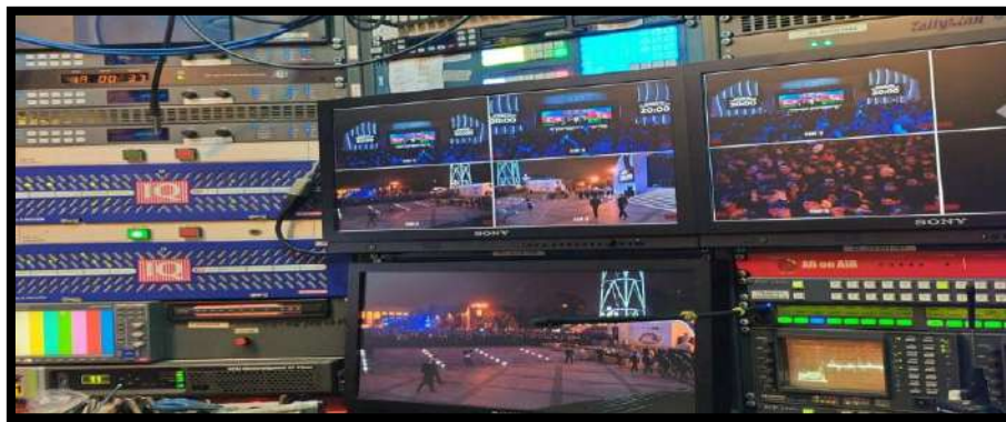
Şəkil 2. Səyyar televiziya stansiyasının video nəzarət hissəsi.
